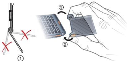
Откидная панель может отсоединяться.
